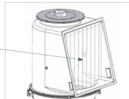
cappa in materiale alimentare plastico antistatico con bandinelle Antistatic food-grade plastic hood with flexible straps
