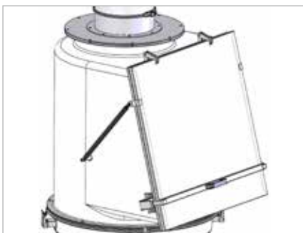
Cappa in materiale alimentare plastico antistatico con portello e molle a gas Antistatic food-grade plastic hood with lid and gas springs
