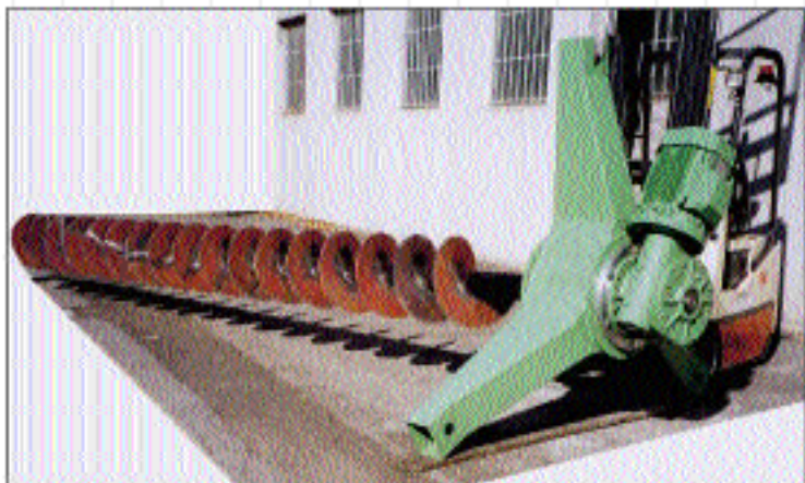
Coclea di miscelazione diam.500 mm
