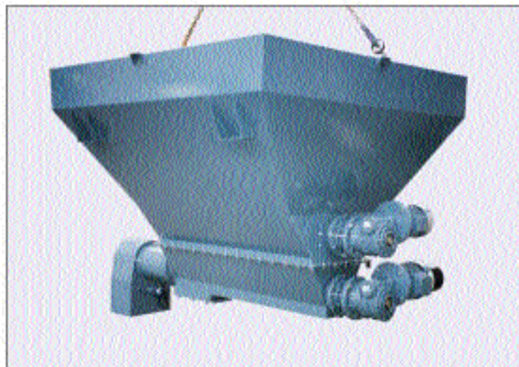
Gruppo di estrazione a coclea completo di rompiponte. Regolazione dei giri coclea con inverter
