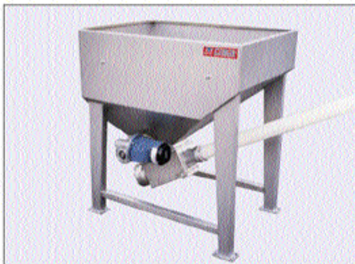
Tramoggia tipo TPA 300 in acciaio inox AISI 304 completa di griglia di protezione e rompiponte
