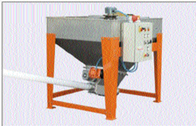
Tramoggia con rompiponte a tre pale sul fondo ed indicatori di livello per il funzionamento in automatico del trasportatore Hopper with three blades bottom bridge-breaker and level indicators for automatic conveyor operating
