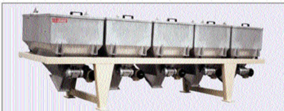
Batteria di tramogge in acciaio inox montate su tasselli elastici complete di coperchio ed elettrovibratore a masse eccentriche
